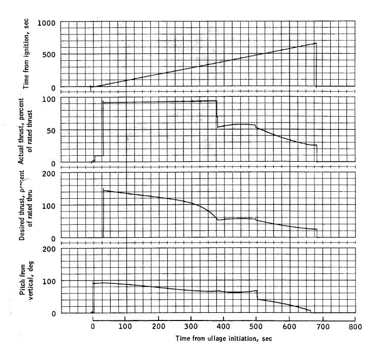
Figure .- Time histories of trajectory parameters for case number 727.29.
