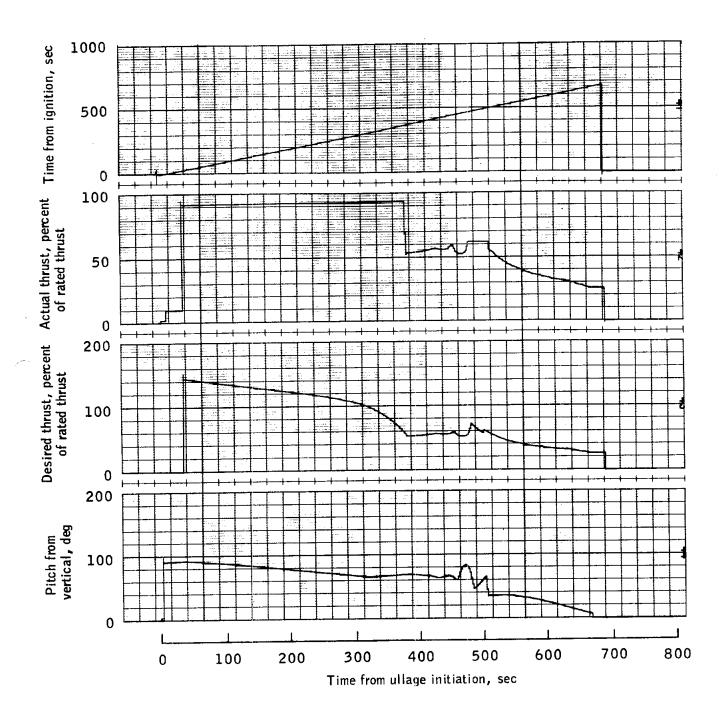
Figure .- Time histories of trajectory parameters for case number 802.16.
